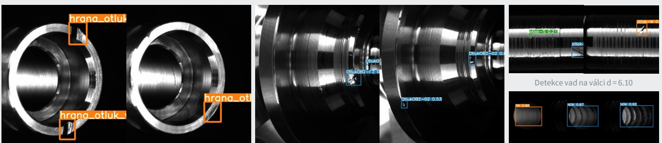
Detekce poškození čela Ø = 6.0
